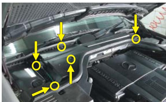
PL Odkręcić wkręty pokrywy filtra, usunąć pokrywę
